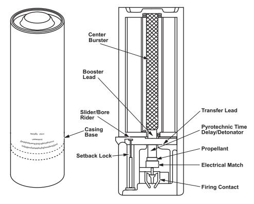
Figure D-9. M76 Smoke Grenade.
